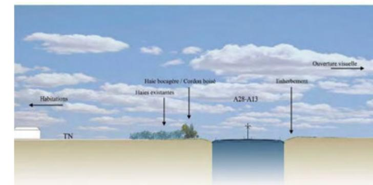
FIGURE 290 : COUPE TYPE SUR UN DEBLAI AVEC HABITATIONS PROCHES
